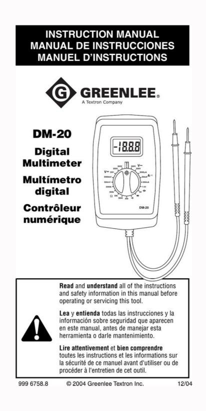
Lire attentivement et bien comprendre toutes les instructions et les informations sur la sécurité de ce manuel avant d'utiliser ou de procéder à l'entretien de cet outil. 999 6758.8 © 2004 Greenlee Textron Inc. 12/04 Description The Greenlee DM-20 Digital Multimeter is a hand-held testing device with the following measurement capabilities: AC and DC voltage, DC current, and resistance.
